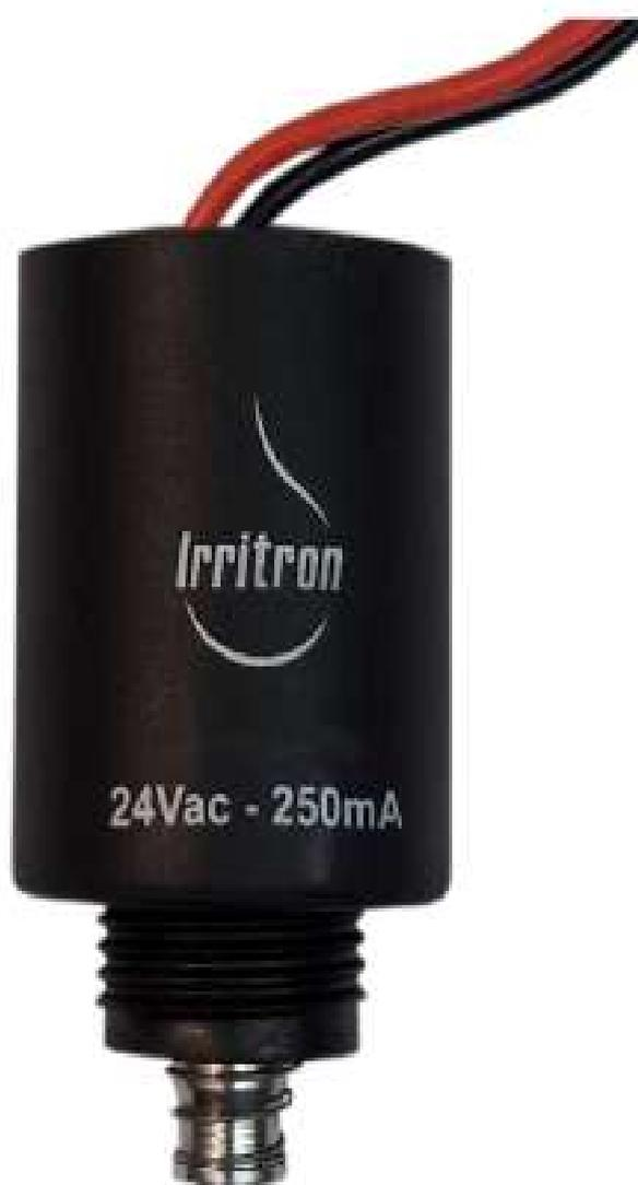
São específicos para automação com comando elétrico, em que os solenóides ficam instalados nas válvulas dos setores e a comunicação entre o controlador e os solenóides se dá por cabos elétricos. Em operações manuais para limpeza das redes e testes gira-se o solenóide em  $\frac{3}{4}$  de volta e a válvula se abre.
