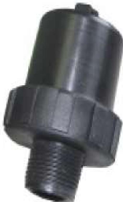
Simple, precisa, funcional e de baixo custo. Injetada em plástico de engenharia alta resistência mecânica, com proteção contra os raios ultravioleta, o que garante longa vida útil, mesmo exposta às variações climáticas. Exclusiva vedação em PVC ultra flexível. Permite o dreno do ar das tubulações quando a motobomba entra em funcionamento. Permite a entrada de ar quando a motobomba é desligada, evitando pressões negativas no interior das tubulações.
