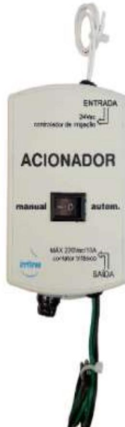
Aparelho eletrônico desenvolvido para acionar automaticamente motores elétricos, quando recebe comando de um controlador. Substitui com vantagens os contadores auxiliares de 24 volts, instalados nos quadros de comando.
