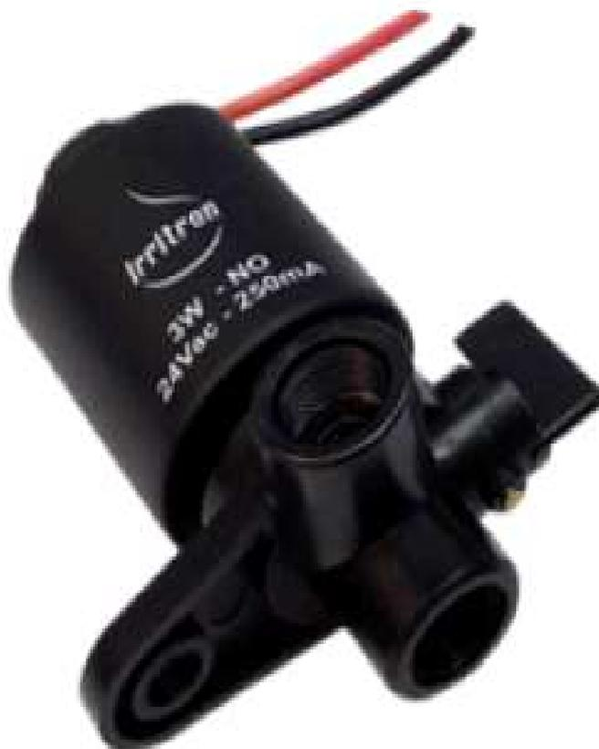
São específicos para automação com comando hidráulico, em que os solenóides ficam próximo ao controlador e a comunicação com as válvulas dos setores de irrigação, espalhadas pela área irrigada, é feita através de microtubos pressurizados. As bases possuem chave para operação manual, em caso de pane elétrica ou quando se queira testar o sistema manualmente.
