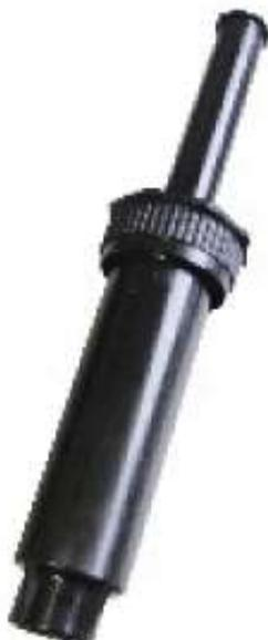
O Acqua Spray é um aspersor escamoteável de 1/2" versátil e com ótima distribuição de água por todo o seu raio de alcance, devido ao jato turbilhonado. É o único spray do mercado que vem de série com válvula anti dreno incorporada. É injetado em termoplástico altamente resistente, com mola retrativa em aço inoxidável. Disponível com bocais de 180° ou 360°, permitindo, no entanto, utilização de bocais com angulação diferente, de outras marcas.
